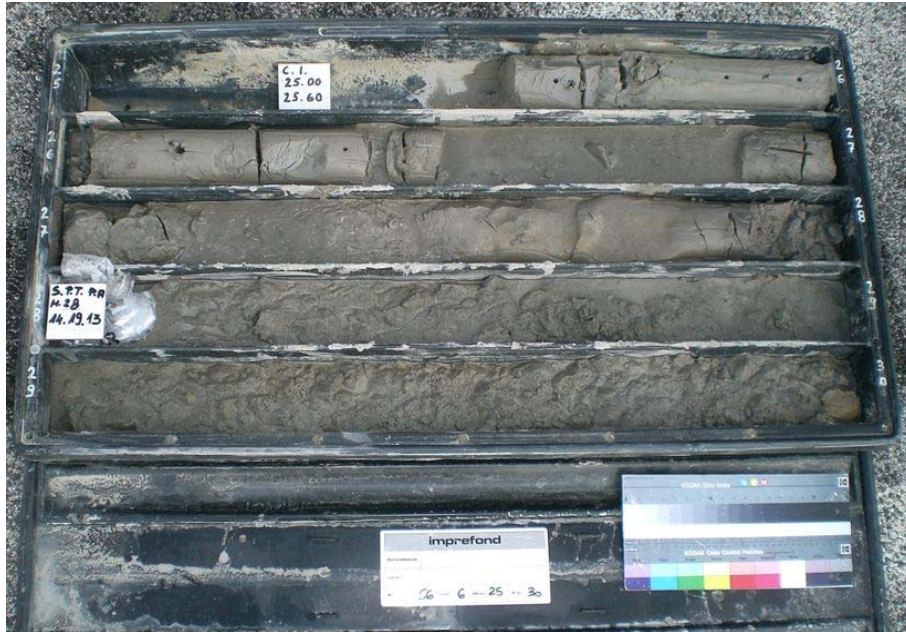
Figura 6 – Cassetta catalogatrice - carotaggio in terreni
