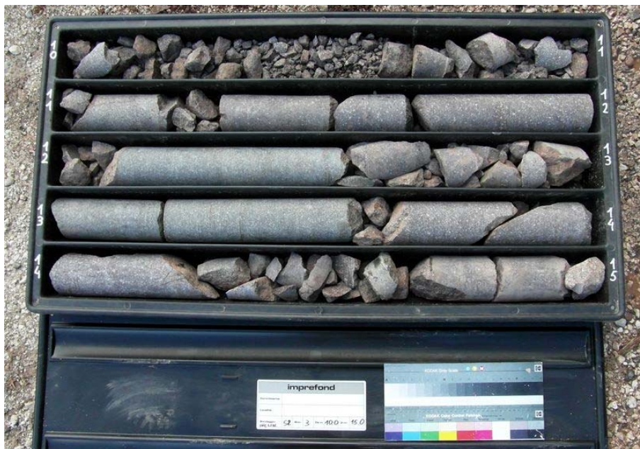
Figura 7 – Cassetta catalogatrice – carotaggio in roccia
