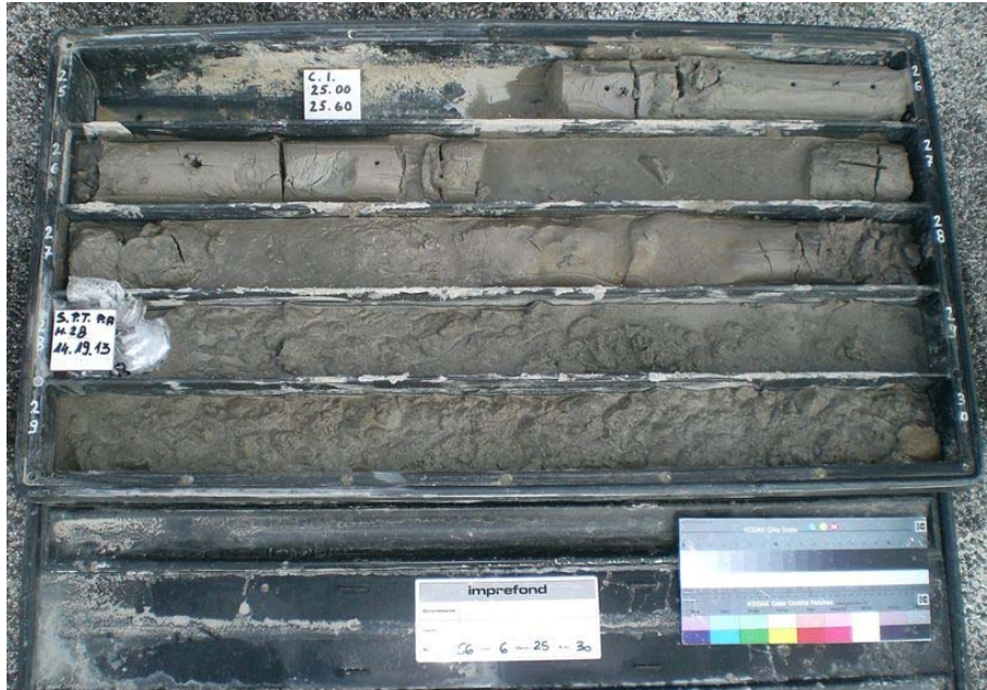
Figura 6 – Cassetta catalogatrice - carotaggio in terreni
